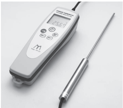
東亜計器製作所 高精度デジタル標準温度計「スタンダードサーモ」 TOA-PT01 標準価格5万9000円(税込)(センサ TOA-PTS150 付属)
